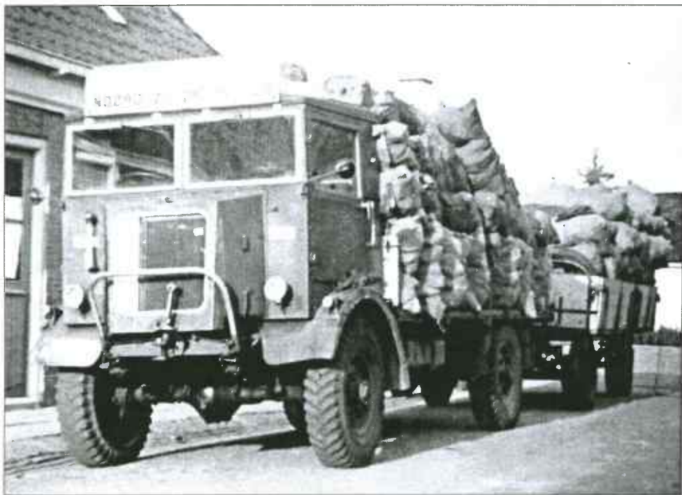
Een Bedford QL uit Engelse legerbestanden is beladen met zakken turf. Die haalde de Jong uit het veen bij Nieuw Weerdinge. De vierwielaandrijving van deze auto was een noodzakelijke voorwaarde voor het rijden op velden en ongebaande wegen. Hij staat geparkeerd voor de werkplaats van schildersbedrijf Klaver aan de Schipperstraat te Noordhorn
